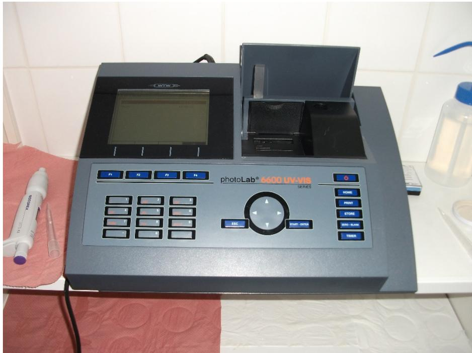
*Figure 7 : Spectrophotomètre 7600 UV-VIS de marque WTW – XYLEM*
