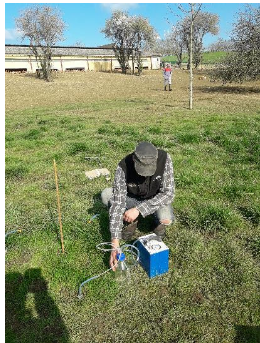
Photographies 14 : Installation de bougies poreuses
