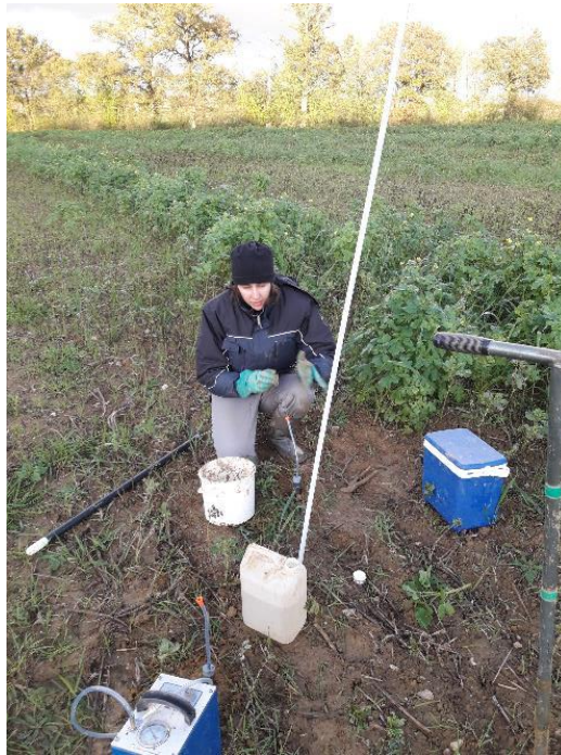
Photographie 13 : Installation des bougies poreuses le 7 et 12 novembre 2019 dans les champs de culture
