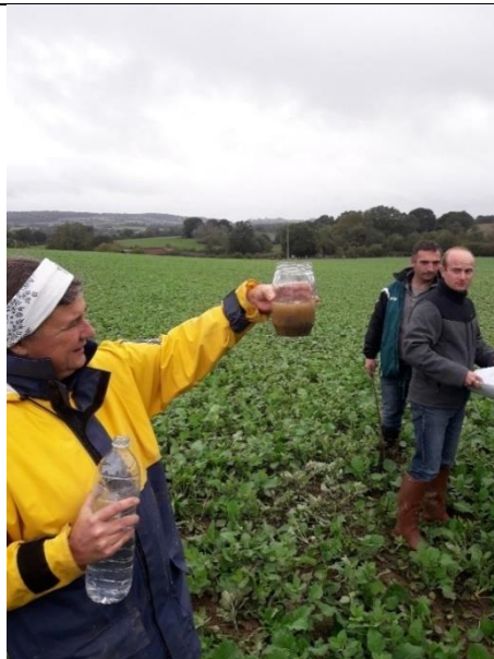
Photographie 10 : Test de structure du sol
