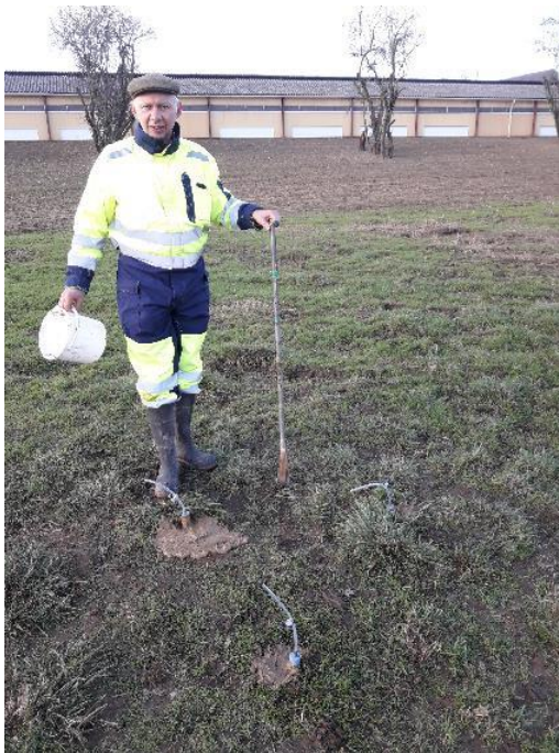
Photographies 14 : Installation de bougies poreuses
