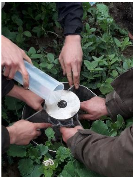
Photographie 9 : Test d'infiltration de l'eau
