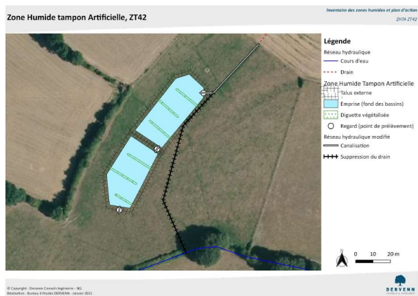
Figure 2. Schéma de principe d'une ZHTA en série à gauche ; exemple de plan d'une ZHTA à droite (sources : ONEMA et CEMAGREF, 2015)
