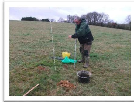
Image 3 - Bougie poreuse posée
